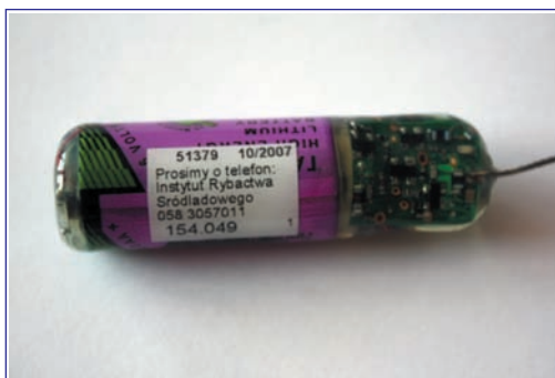
Fot. 9. Znaczek radiowy wykorzystywany w metodzie telemetrycznej (fot. P. Dębowski).
