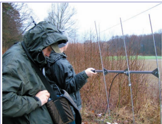
Fot. 11. Śledzenie przemieszczania się znakowanych ryb za pomocą anteny kierunkowej (fot. P. Dębowski).
