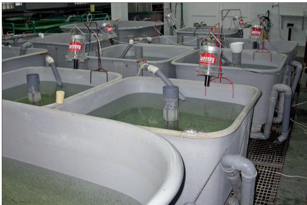
Fot. 2. Doświadczalny system recykulacyjny, w którym przeprowadzono chów sielawy i siei.
