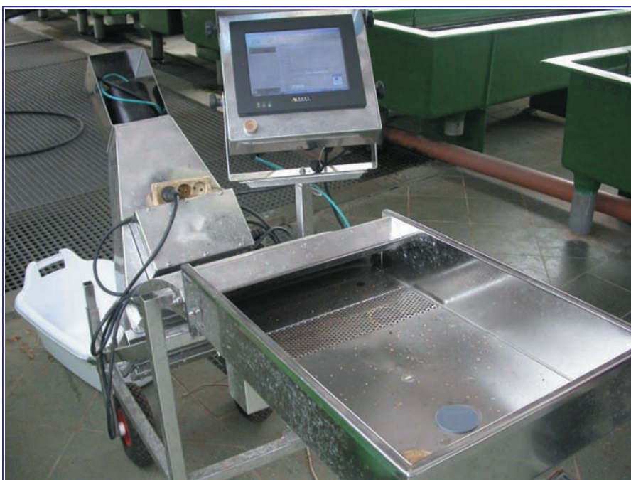
Fot. 3. Licznik narybku z wykorzystaniem analizy obrazu.
