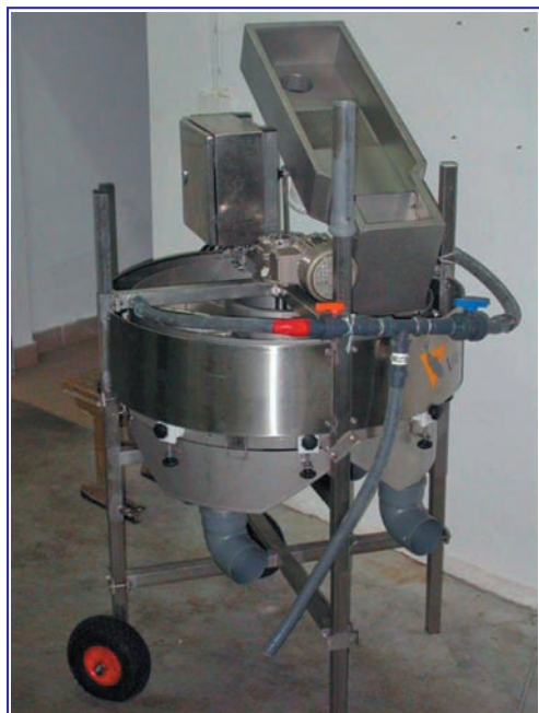
Fot. 1. Nowoczesna sortownica umożliwiająca jednocześnie rozdzielanie sortowanych ryb na cztery grupy wielkościowe.
