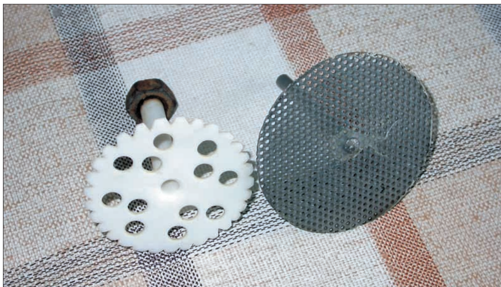
Fot. 2. Grzybki z tworzywa sztucznego i metalu do rozpraszania przepływu wody w aparatach Weissa.
