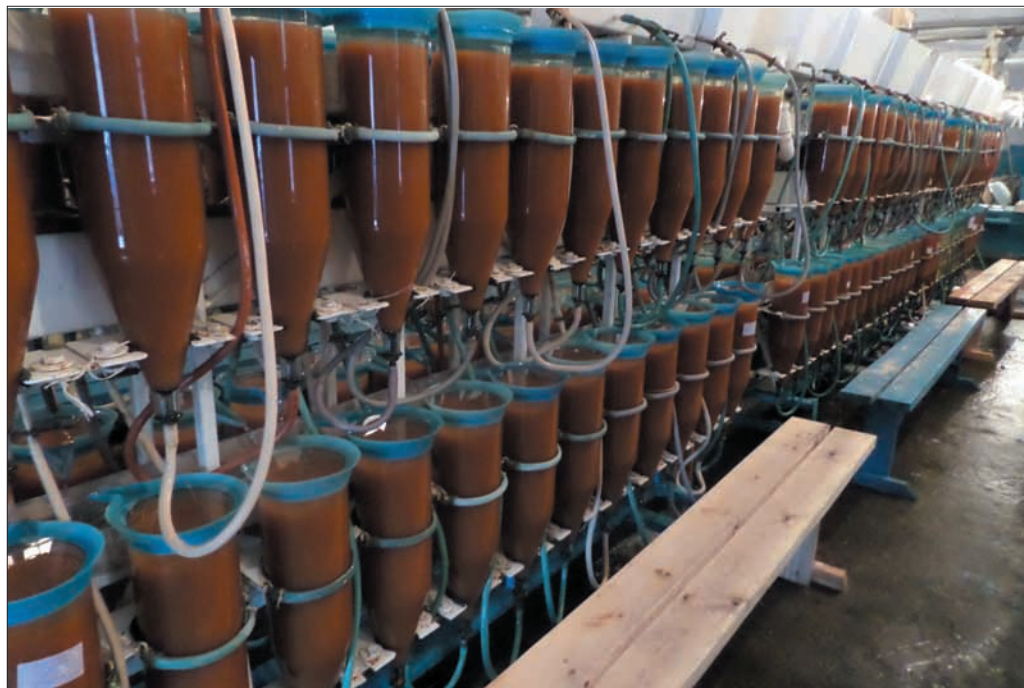
Fot. 8. Aparaty inkubacyjne usytuowane w dwóch rzędach jeden nad drugim.
