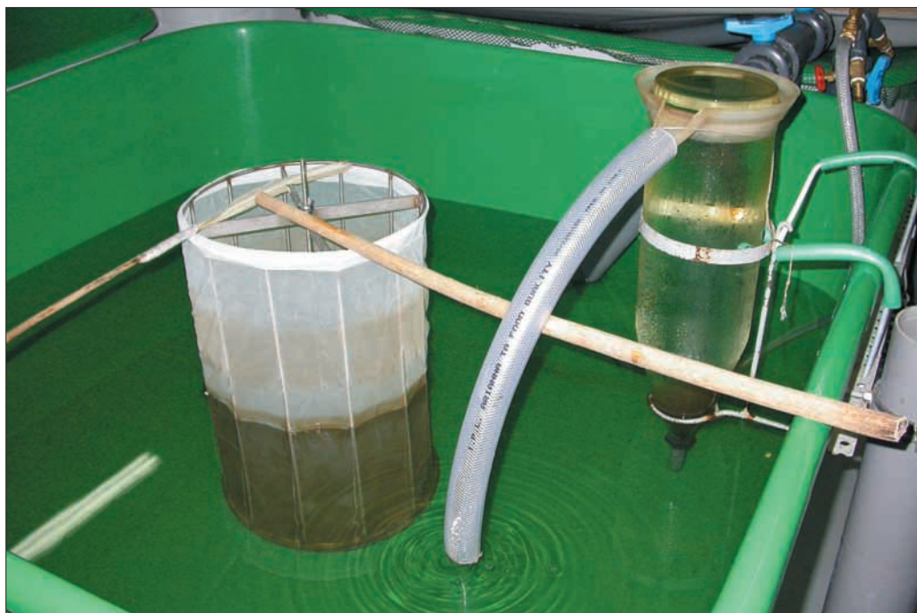
Fot. 9. Aparat Weissa w przenośnym stelażu, umieszczony w basenie-podchowalniku.
