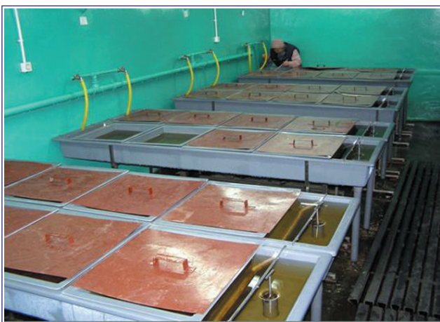
Fot. 3. Aparaty kalifornijskie do inkubacji ikry ryb łososiowatych.
